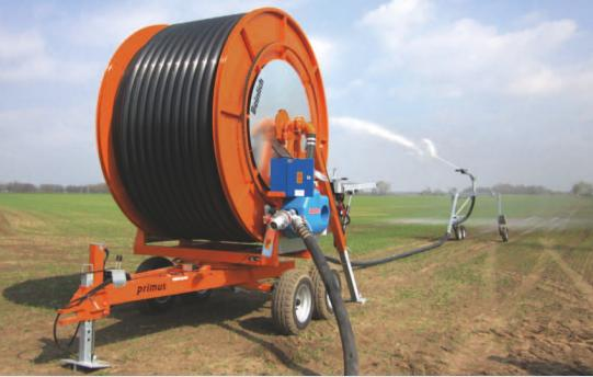
Bodenfreiheit 500 mm, Spurweite 1.8 m - 2.0 m
