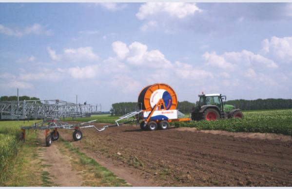
Dank 4-Radlenkung läuft der Düsenwagen exakt in der Traktorspur nach
