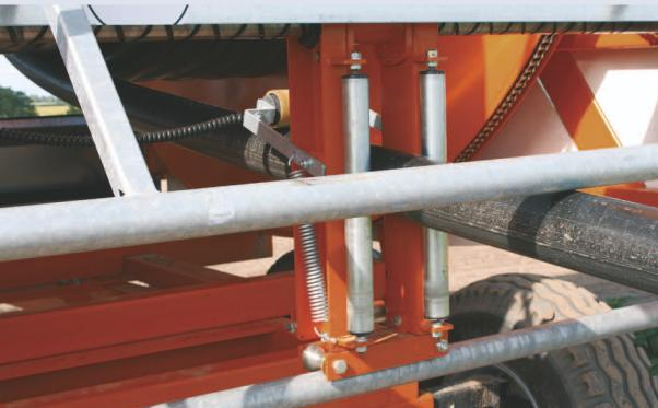
Der 3-teilige Spulwagen und die zusätzliche Führungsschiene garantieren einen verschleißarmen Einsatz bei hohen Belastungen.
