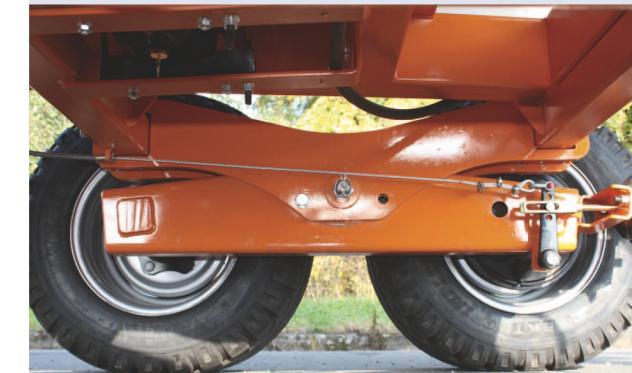
Pendelachse mit Druckluftbremse an 2 Rädern
