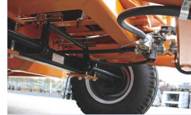
Vordere Achse mit Jost Drehkranz, 45° lenkbar
