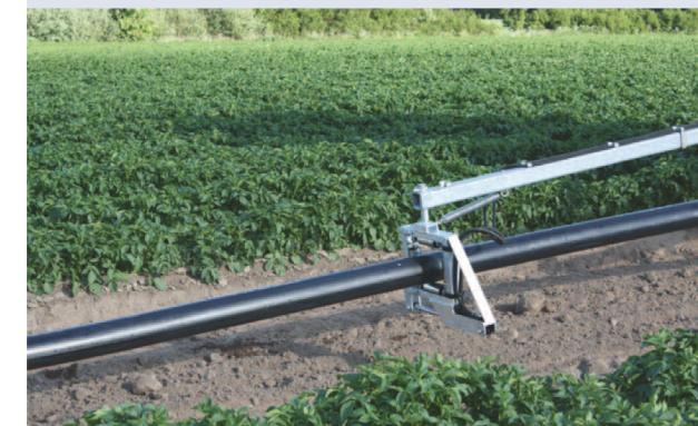
Führungsrollen öffnen und schließen hydraulisch
