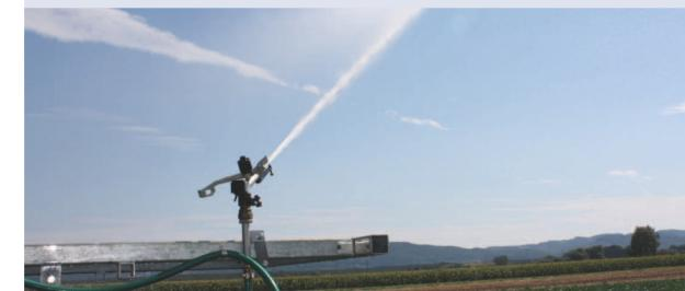
Regner K1 8° für 15 m Wurfweite, horizontal montiert auf der Hebevorrichtung
