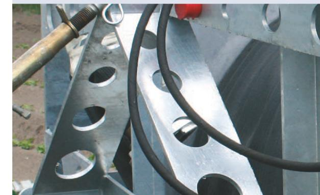
Die verzinkten Tragrahmen B 600 und B 800 verfügen über einen Stützfuß
