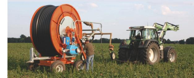
Nach 180°-Schwenk der Trommel zieht der Traktor das Rohr aus
