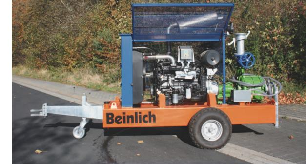
Typ IR 250-10: Motor 200PS, Pumpe 280m<sup>3</sup>/h
