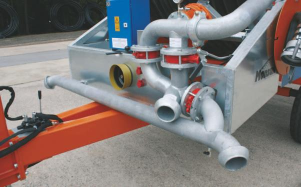
Abschaltklappe, Regelklappe, mech. Abschaltklappe und beidseitige Wassereinspeisung
